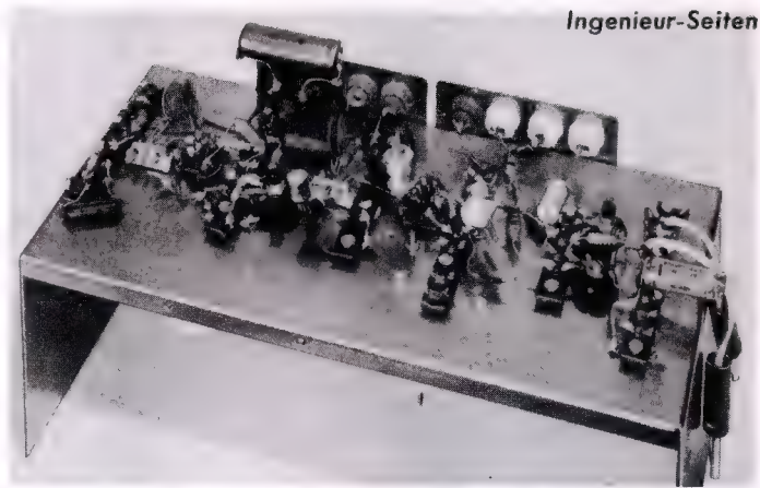
Bild 5. Versuchsaufbau des Ratiodektors. Links befindet sich die Treiberstufe mit dem Transistor OC 170, rechts der Ratiodektor mit den Dioden OA 90
