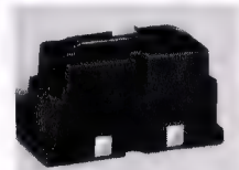
Bild 1. Aufbau des Hör-Sprech-Löschkopfes für Diktiergeräte
