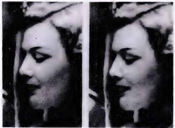
Bild 8. Vom Vidikon-Normwandler umgeformtes 405/625-Zeilen-Bild. a) mit Interferenzstreifen, b) ohne Interferenzstreifen nach Einschalten des 21-MHz-Wobbelszusatzes
