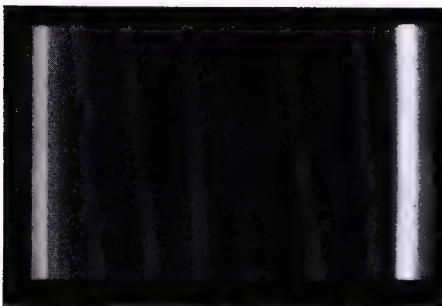
Bild 7. Mehrfachabbildung eines rasch durch das Bildfeld von links nach rechts wandernden hellen Balkens
